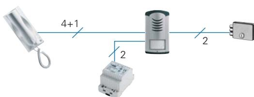
Schemi di montaggio del Kit 1129/502 (v2)
