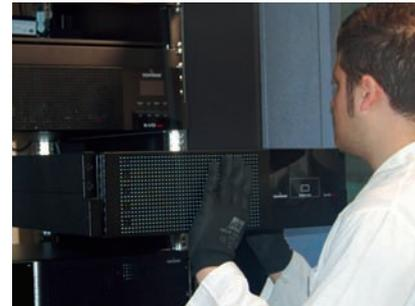
Per permettere una facile installazione, il Battery Box ed i Battery Pack vengono forniti separati, all'interno dell'imballo.
