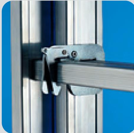
I pioli con superficie d'appoggio di mm 30 vengono fissati ai montanti tramite ribordatura. Sono zigrinati e antisdrucciolo per una solida presa di mani e piedi. Un gancio di sicurezza impedisce lo sfilo accidentale dell'ultimo tronco.
