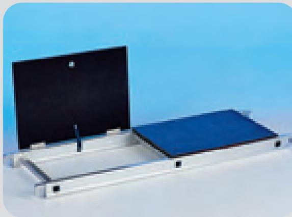
Piano di calpestio in alluminio e legno multistrato verniciato contro le intemperie e antisdrucciolo. Un gancio anti - vento assicura ogni piano al resto della struttura per evitarne movimenti accidentali. L'ultimo gradino utile per il piano di calpestio e per la salita sulle scale è verniciato di rosso per essere facilmente riconoscibile. Dotato di fermapiedi a montaggio rapido alti 10 cm.
