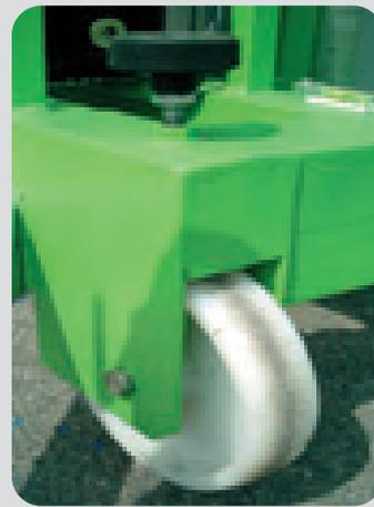
Ruote posteriori con dispositivo di bloccaggio
