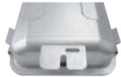
**MANUTENZIONE** Blocco unico riflettore-alimentatore-portalampade. Tutto il blocco (che rimane appeso in fase di manutenzione) è rapidamente rimovibile senza utensili: girando di 90° le due manopole di blocco, grazie al sezionatore di linea che disconnette la alimentazione elettrica. Durante la manutenzione il vetro resta incernierato al corpo. Clips robuste, imperdibili, facilmente manovrabili
