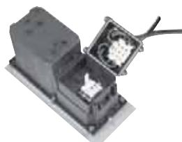
Per l'alimentazione utilizzare unicamente cavi H07RN-F 2x1,5 di Ø7÷12mm. Altri cavi potrebbero non garantire il grado di protezione IP67. Utilizzando l'accessorio A0323 è possibile alimentare gli apparecchi in fila continua. Con cavo H07RN-F 2x1,5mm<sup>2</sup>, su una lunghezza max 100m, si possono installare max n° 56x9W o max n° 23x26W o max n° 13-2x20W o n°28-20W.
