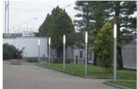
I modelli KHA slim per lampade fluorescenti compatte dispongono di diffusori in policarbonato stabilizzato ai raggi UV. I diffusori sono traslucidi con finitura satinata, offrono una piacevole visione dell'apparecchio spento e una emissione luminosa a 360°, soft e confortevole per l'osservatore.
