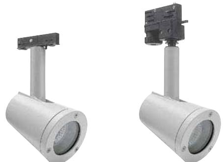
TYCO 10 sono dei piccoli proiettori per lampade alogene o dicroiche, a bassa tensione (12V), per tensione di rete (220/240V) e per sistemi LED. Sono costruiti in alluminio resistente alla corrosione, con elevato grado di protezione IP 66, in Classe II e Classe III, per uso esterno ed interno.
