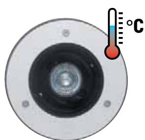
Se l'apparecchio è accessibile al pubblico è opportuno assicurarsi che la temperatura del vetro, (rilevata a 230V e indicata a lato di ogni modello **T max °C**), sia compatibile con le relative norme locali di installazione.
