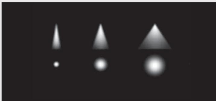
3 diverse ottiche, per fasci simmetrici da 2x4° a 2x33° per massimizzare l'efficienza e la versatilità del layout illuminotecnico.
