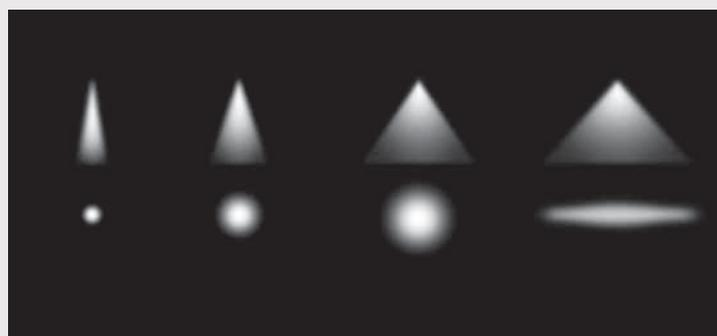
Ampia scelta del fascio di luce (21 diverse ottiche, per fasci simmetrici da 2x5° a 2x39° oltre ai fasci Wall Washer Mira) per massimizzare l'efficienza e la versatilità del layout illuminotecnico.
