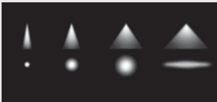
Ampia scelta del fascio di luce (4 diverse ottiche, per fasci simmetrici da 2x5° a 2x29° oltre ai fasci Wall Washer Mira) per massimizzare l'efficienza e la versatilità del layout illuminotecnico.
