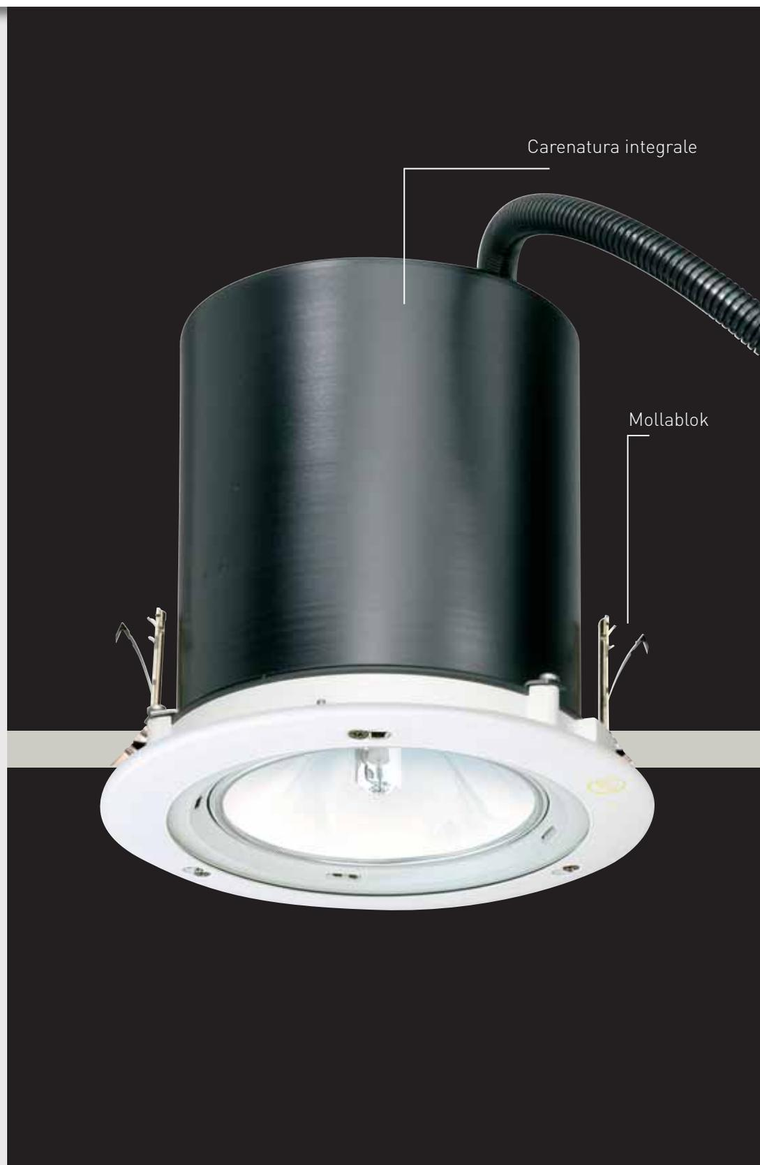
Installazione rapida con sistema Mollablok per l'ancoraggio a controsoffitti da 0 a 35 mm di spessore.
