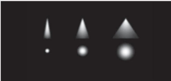
3 diverse ottiche, per fasci simmetrici da 2x7° a 2x25°, per massimizzare l'efficienza e la versatilità del layout illuminotecnico.
