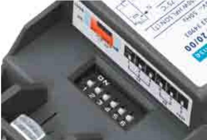
**Sistema di controllo per la regolazione di reattori magnetici multi potenza in apparecchi per esterni**
