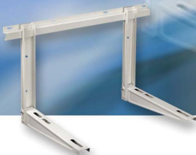
**S**TAFFE per unità esterna modello MER con traversa in acciaio elettrozincato e verniciate con polveri in poliestere altamente resistenti agli agenti atmosferici, con trattamento a forno a 180°C con spessore applicato di 70 mics.
