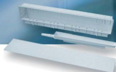
A scatola predisposizione da incasso realizzata in materiale plastico permette di predisporre un' impianto di condizionamento incassando la scatola per il fissaggio dell' unità interna e il tubo per lo scarico condensa. È completa di tasca raccolta condensa reversibile (dx e sx). Innesto tubo scarico condensa universale.
