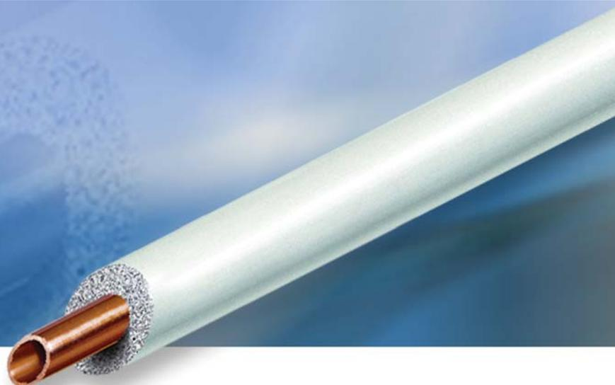
Il tubo di rame WELTUB con il nuovo rivestimento in polietilene espanso a celle chiuse è idoneo all' utilizzo in impianti di refrigerazione e di climatizzazione. Il suo elevato grado di pulizia interna ed il suo isolamento rendono WELTUB particolarmente adatto per il passaggio di gas frigoriferi e liquidi refrigeranti. Idoneo ai gas R407C e R410A.
