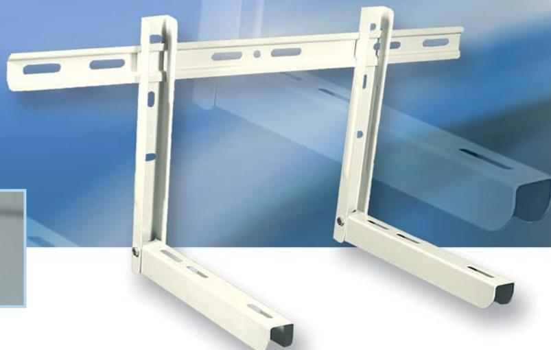
**S**TAFFE per unità esterna modello MER con traversa in acciaio elettrozincato e verniciate con polveri in poliestere altamente resistenti agli agenti atmosferici, con trattamento a forno a 180°C con spessore applicato di 70 mics.
