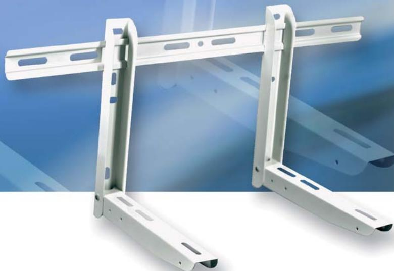
**S**TAFFE per unità esterna modello MER con traversa in acciaio elettrozincato e verniciate con polveri in poliestere altamente resistenti agli agenti atmosferici, con trattamento a forno a 180°C con spessore applicato di 70 mics.
