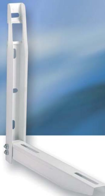
**S**TAFFE per unità esterna modello MES senza traversa in acciaio elettrozincato e verniciate con polveri in poliestere altamente resistenti agli agenti atmosferici, con trattamento a forno a 180°C con spessore applicato di 70 mics.
