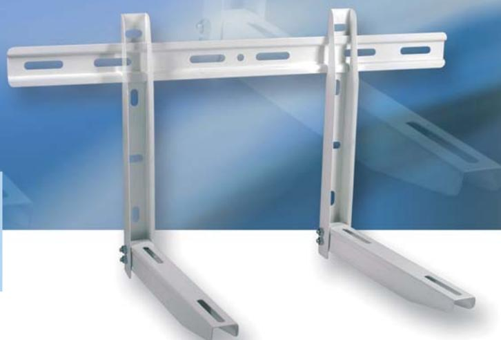
**S**TAFFE per unità esterna modello MER con traversa in acciaio elettrozincato e verniciate con polveri in poliestere altamente resistenti agli agenti atmosferici, con trattamento a forno a 180°C con spessore applicato di 70 mics.
