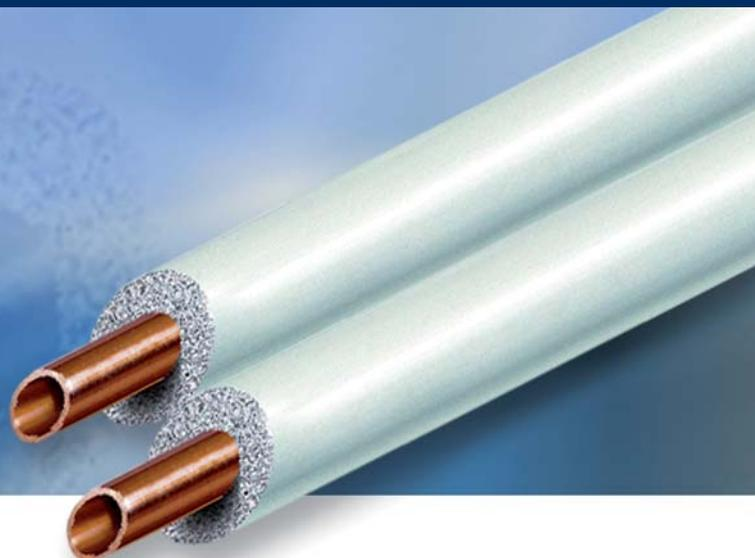
Il tubo di rame WELTUB con il nuovo rivestimento in polietilene espanso a celle chiuse è idoneo all' utilizzo in impianti di refrigerazione e di climatizzazione. Il suo elevato grado di pulizia interna ed il suo isolamento rendono WELTUB2 particolarmente adatto per il passaggio di gas frigoriferi e liquidi refrigeranti. Idoneo ai gas R407C e R410A.
