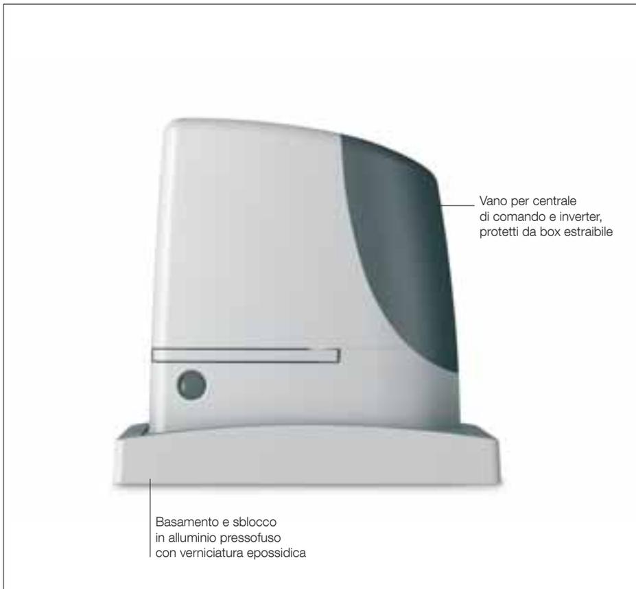
**Per l'automazione di cancelli scorrevoli fino a 1800 kg (RUN1800) e 2500 kg (RUN2500). Motore autoventilato con finecorsa induttivo (RUN1800P/RUN2500P) e con finecorsa elettromeccanico (RUN1800/RUN2500/RUN2500I).**
