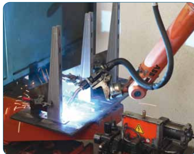
Reparto saldature eseguite con sistemi robotizzati Robotized welding department
