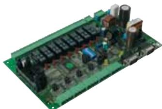
Il Multi I/O è un dispositivo che integra l'UPS con un sistema di controllo tramite segnali di ingresso e uscita a relè, completamente configurabile. Permette di collegare due dispositivi ad un'unica porta di comunicazione seriale dell'UPS.
