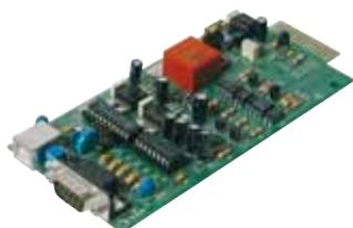
L'accessorio Multicom 362 consente all' UPS di comunicare via linea seriale RS232 o in alternativa tramite porta USB attraverso la porta di comunicazione ausiliaria. Consente di collegare gli UPS non dotati di porta di comunicazione USB a computer Apple Macintosh, o computer con sistema operativo Windows o Linux.
