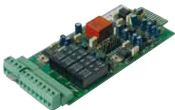
L'accessorio Multicom 382 fornisce una serie di contatti a relè per la gestione degli stati e allarmi dell'UPS. La scheda è fornita di due morsetti estraibili. Su una di queste morsetti si trova il segnale ESD (spegnimento dell'UPS in caso di emergenza) e il segnale RSD (Shut down remoto). La scheda presenta inoltre la possibilità di associare le segnalazioni
