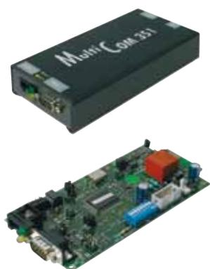
Il duplicatore di seriale MultiCOM 351/352 è un accessorio che permette di collegare due dispositivi ad un'unica porta di comunicazione seriale dell'UPS. Utilizzabile in tutti i casi in cui ci sia la necessità di avere più connessioni seriali per l'interrogazione multipla dell'UPS, e' la soluzione ideale per reti LAN con Firewall, dove è necessario un elevato grado di sicurezza, o per la gestione di reti LAN separate alimentate da un unico UPS.
