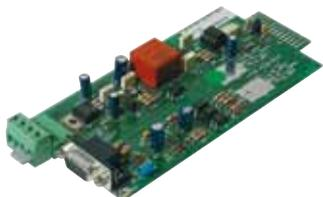
L'accessorio Multicom 372 consente di aggiungere all'UPS una porta di comunicazione per il controllo ed il monitoraggio dell'UPS stesso via linea seriale RS232.
